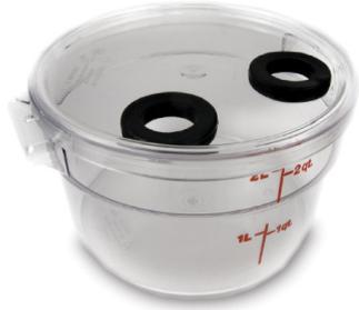
2000 mL 크기의 플라스틱 용기로 산소 센서와 이산화탄소 센서를 연결하여 화학 및 생물 실험에서 기체상태의 산소와 이산화탄소의 양을 측정 할 수 있습니다. 그 외 다음과 같은 실험에 산소 센서 또는 이산화탄소 센서와 함께 바이오챔버를 사용할 수 있습니다.
