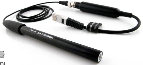
버니어 Tris pH센서는 용액 및 반고체 물질의 pH를 측정하는데 사용됩니다. 유리막이 동그랗지 않고 평평하기 때문에 내구성이 좋고 세척하기가 용이하며 평평한 표면이나 크기가 작은 샘플을 측정하는데 더욱 용이합니다. 주요 특징으로는 젤이 들어있는 밀봉된 이중접합 전극을 사용하기 때문에 Tris buffer에 사용할 수 있으며, 단백질이나 황화물이 들어간 용액의 pH를 측정할 수 있다는 것입니다.
