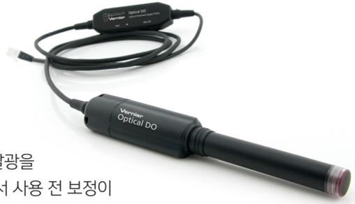
용액의 용존 산소 농도를 측정하는 센서로 빛의 발광을 기반으로 한 광학 산소 센서입니다. 이 기술로 센서 사용 전 보정이 필요 없으며 산소를 소모하지 않기 때문에 측정 시 저어 가며 측정을 할 필요가 없습니다. 용존 산소 레벨의 변화는 다양한 실험과 수중 환경 품질의 1차 지표 중 하나로 사용됩니다. 본체부분은 방수이며 마이크로SD카드가 포함된 박스는 변형 방지의 끝부분 까지 최대 1.6m 물속에 잠길 수 있습니다. 마이크로SD 카드가 포함된 부분은 방수가 되지 않습니다. 다음의 목적으로 사용이 가능합니다.
