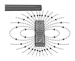
이 센서는 각 방향에 따른 장기장의 벡터 성분을 측정합니다. 한 위치에서 자기장 세기의 총량을 측정하기 위해서는 x-방향(기본설정)만 측정이 가능하고 측정하려는 위치의 자기장의 방향을 향하도록 합니다. 다른 옵션은 소프트웨어에서 계산된 열 생성 기능을 사용하는 것입니다. 자기장 크기는 3개의 모든 축의 제곱 합의 제곱근으로 계산됩니다. 이 방식으로 학생들은 3차원의 벡터를 접할 수 있습니다.
