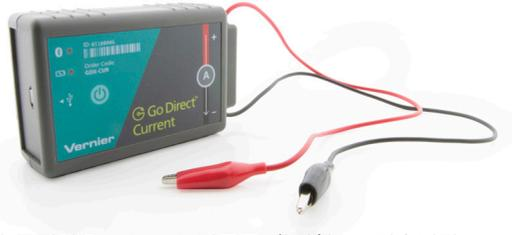
고 무선 전류 센서는 전기의 기본원리를 탐구하기 위해 제작되었습니다. 고 무선 전류 센서를 이용해 크지않은 AC, DC 전류를 측정할 수 있습니다.  $\pm 1A$  측정 범위를 가진 이 센서는 대부분 전기전자 회로실험에서 가장 이상적으로 사용이 가능합니다.
