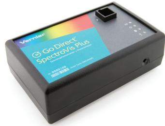
고 무선 스펙트로 VIS plus는 휴대가 가능하며 가시광선에서 근적외선까지의 분광 광도계 및 형광 측정기입니다. 이 스펙트로미터는 화학, 생물, 물리학을 위한 광범위한 분광학 실험에 사용 할 수 있습니다. 이러한 실험에는 Beer의 법칙 연구, 흡광 투과 형광 측정 전체 파장 스펙트럼 수집 반응 속도를 모니터링하는데 사용됩니다.
